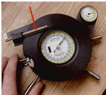
Met een fractometer kan de houtkwaliteit van een boorspaan (rode pijl) worden gemeten.
